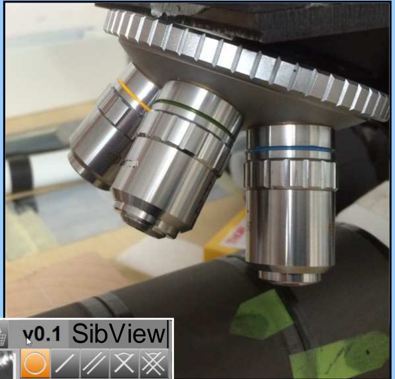
Revolver, mit 5, 10, 20, 40 + 80x Planachromatische Optiken
