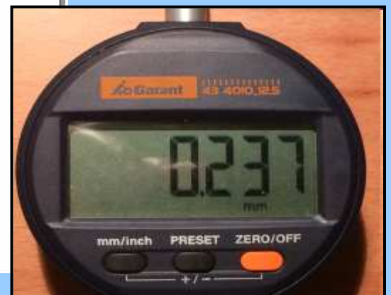
Digitalmikrometer mit Genauigkeitsanzeige von 1µm
